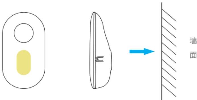
**i** 您还可以使用配件中的螺丝，将报警器挂在选定位置。
