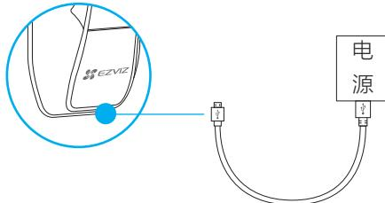
如电池长时间未使用，请打开电池槽取出锂电池，使用电源适配器（5V == 2A，需自备）给电池充电。
